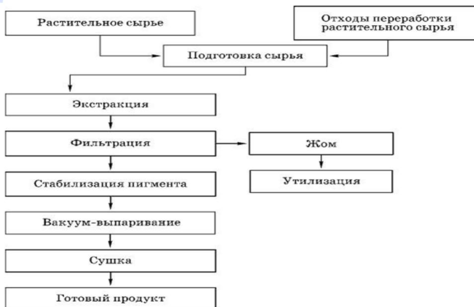
Принципиальная схема производства порошкообразного пищевого энокрасителя
